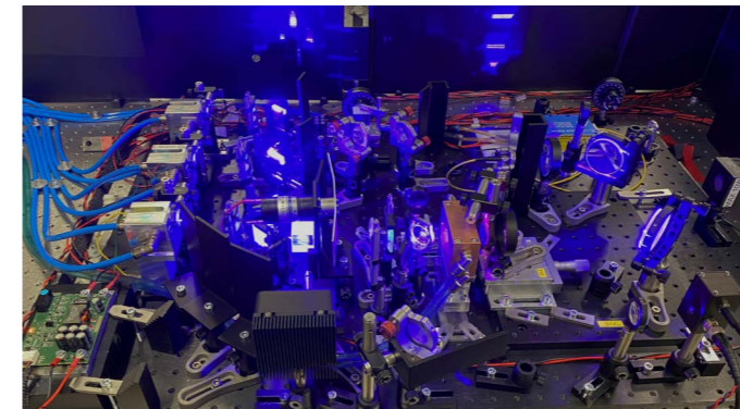
Versuchsaufbau des Femtosekundenlasers. Blaues Licht wird von den neuen Pumpdioden emittiert. (Bild: B. Resan, Institut für Produkt- und Produktionsengineering der FHNW Windisch)
