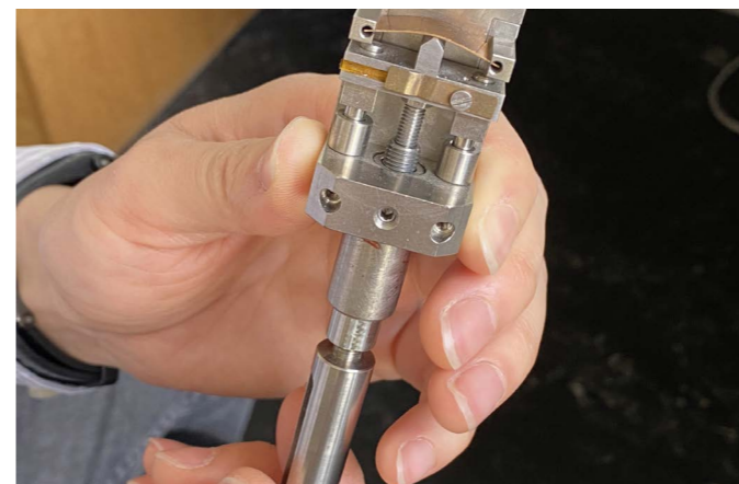
Durch Druck von unten verbiegt sich das Bauelement. Dadurch verlängert sich die eingebettete Graphenschicht und ihre elektrischen Eigenschaften ändern sich. (Bild: Swiss Nanoscience Institute, Universität Basel)
