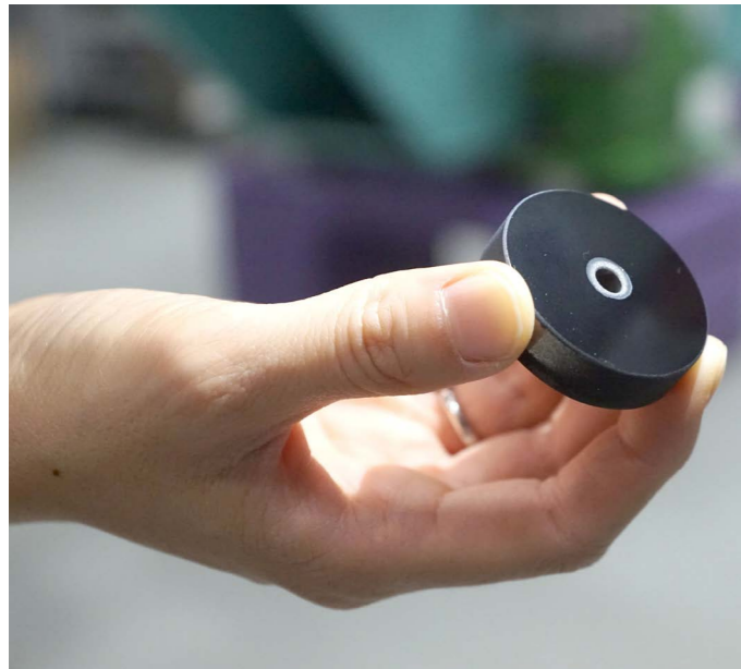
Die Proben wurden mithilfe der Plasmaspray-Methode mit einer Keramikschicht versehen, die dann genauestens untersucht und nachbehandelt wurde.
