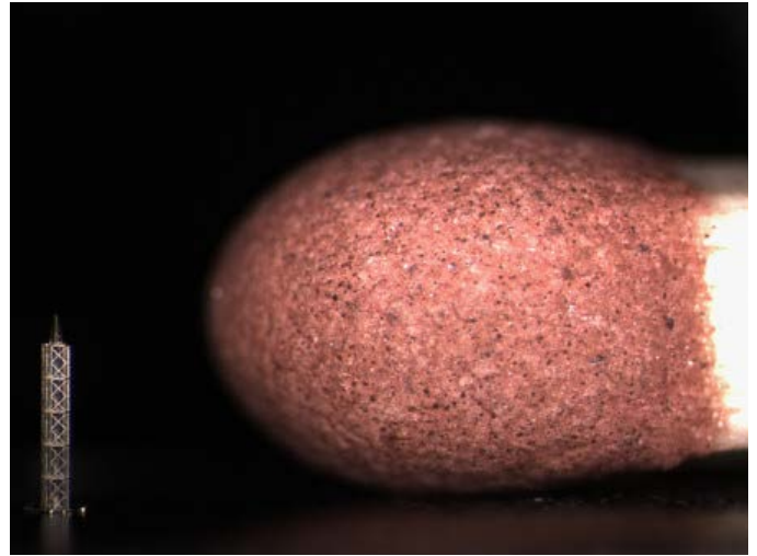
Foto der brechenden Röntgenlinse (linke untere Ecke) im Vergleich zu einem Streichholzkopf. Diese 3D-gedruckte Mikrostruktur wurde mit einer Fresnel-Zonenplatte kombiniert, um die apochromatische Röntgenoptik zu realisieren. (Foto: U. T. Sanli und J. Vila-Comamala, Paul Scherrer Institut)
