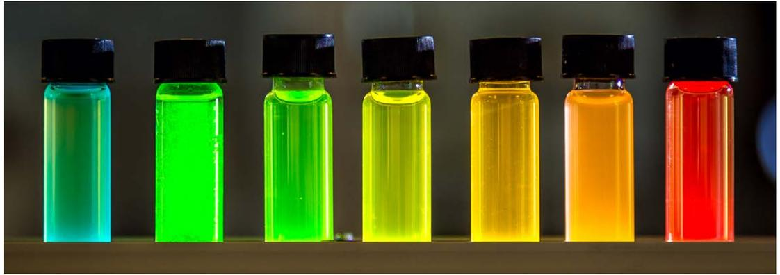
Quantenpunkte sind winzige kolloidale – also fein verteilte – Halbleiterkristalle von nur einigen Nanometern Durchmesser. Je nach Grösse besitzen sie unterschiedliche Eigenschaften – beispielweise ihre Farbe, wenn sie mit Licht angeregt werden. (Bild: Stockphoto)
