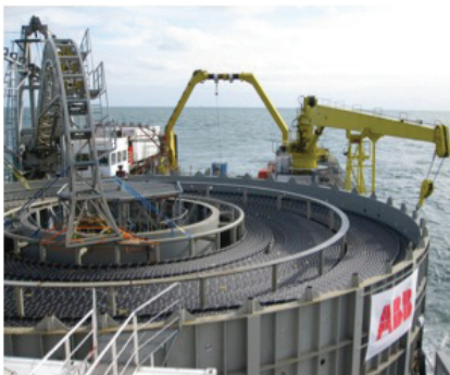
Verlegeanlage für Unterwasser-Hochspannungskabel (Foto: ABB).
